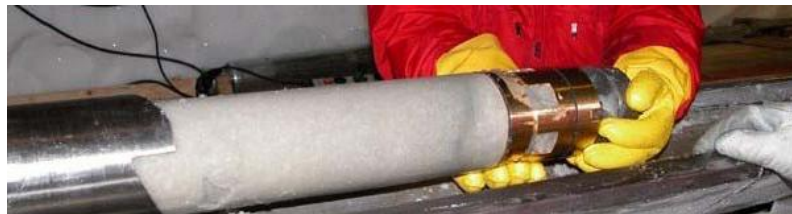
Abbildung 11: Bergung eines Eisbohrkernes
