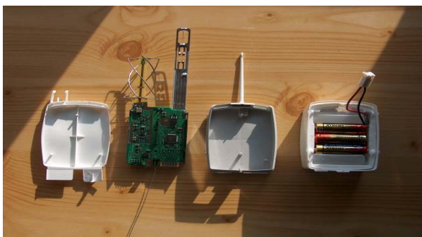
Oben: Foto einer Radiosonde
