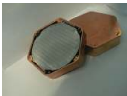
Abb. 5: Kristall mit Hülle und Phonondetektor auf Oberseite
