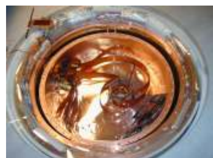
Abb. 7: Turm im Kryostaten, Kupferlamellen dienen der Datenübertragung
